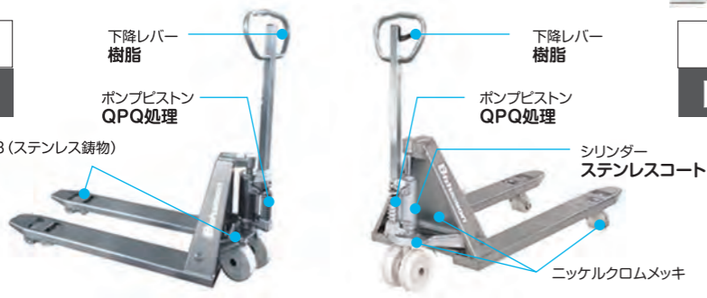
準ステンレス仕様 フォーク部ステンレス、ユニット部ステンレスコート
